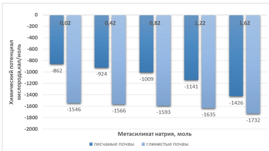
Рисунок 2 – Зависимость активности кислорода от содержания метасиликата натрия в смесях с известняком (песчаные и глинистые почвы)
