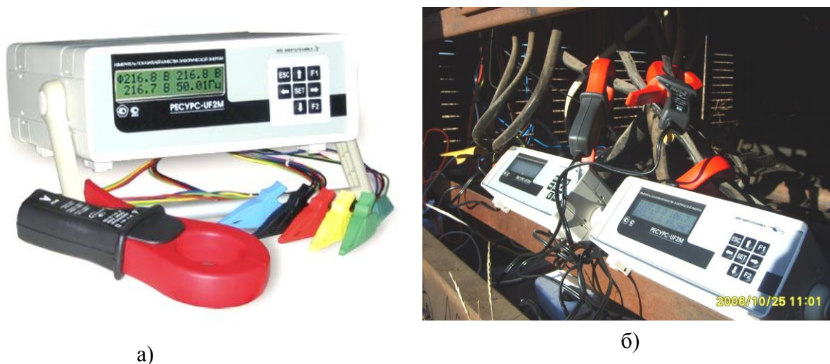
Рисунок 1 – Прибор “Ресурс-UF2M” а) общий вид; б) подключение приборов к электрической сети.
