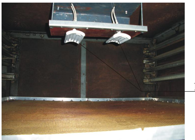
Рисунок 1 – Рабочая камера ИК-установки: 1 – импульсные керамические преобразователи излучения.
