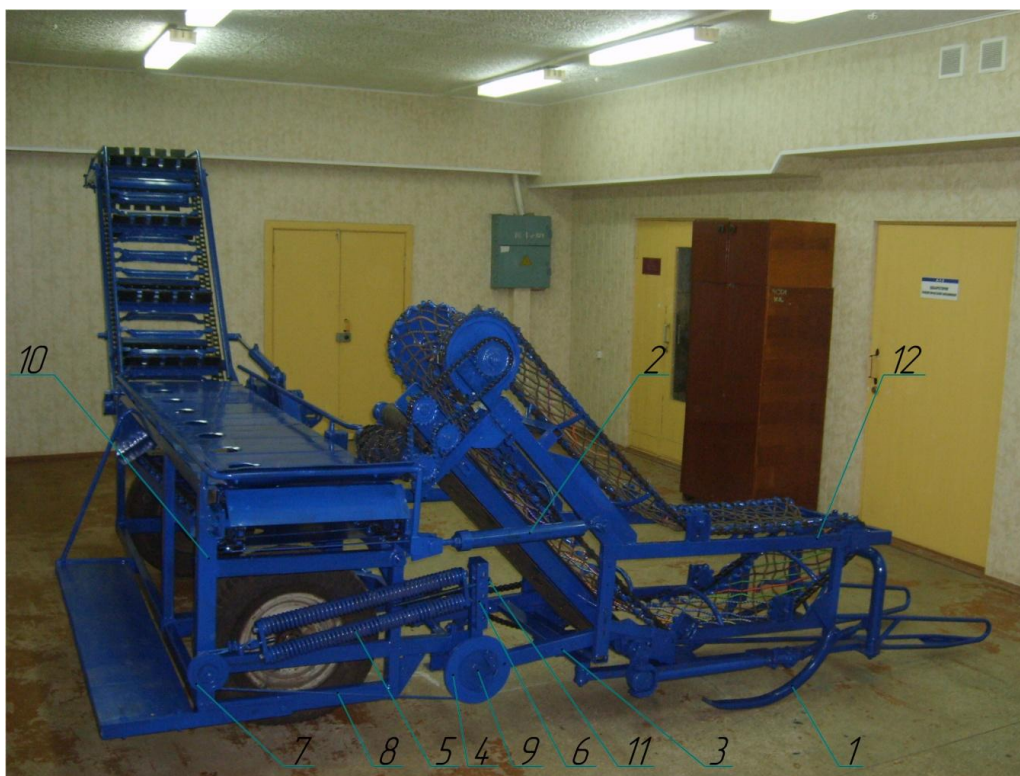
Рисунок 1 - Копирующее устройство капустоуборочного комбайна: 1 – опорные лыжи, 2 – одновинтовой талреп, 3 – прямоугольная труба, 4 – диск, 5 – блок разгружающих пружин, 6 – стойка, 7 – отклоняющий блок, 8 – канат, 9 – ось, 10 – рама машины, 11 – винт, 12 –режущий аппарат.
