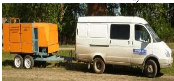
Рисунок 4 – Прицепные агрегаты технического обслуживания и ремонта (ПАТОР): а – внешний вид ПАТОР-А, ПАТОР-ЭУ и ПАТОР-С; б – внутренний вид ПАТОР-С; в – ПАТОР-С в сцепке с автомобилем; г – ПАТОР-А в сцепке с трактором
