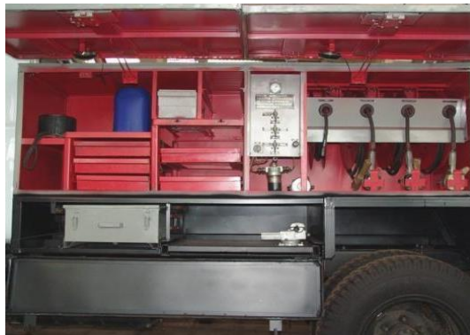
Рисунок 3 – Агрегат технического обслуживания АТО-9994: а – внешний вид агрегата; б – внутренний вид агрегата АТО-9994
