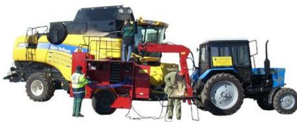
Рисунок 4 – Прицепные агрегаты технического обслуживания и ремонта (ПАТОР): а – внешний вид ПАТОР-А, ПАТОР-ЭУ и ПАТОР-С; б – внутренний вид ПАТОР-С; в – ПАТОР-С в сцепке с автомобилем; г – ПАТОР-А в сцепке с трактором
