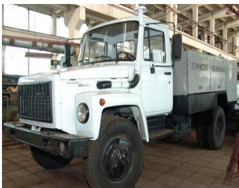
Рисунок 3 – Агрегат технического обслуживания АТО-9994: а – внешний вид агрегата; б – внутренний вид агрегата АТО-9994
