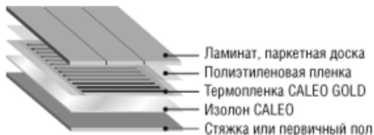
Рисунок 4 – Схема монтажа теплого пола CALEO GOLD [9]
