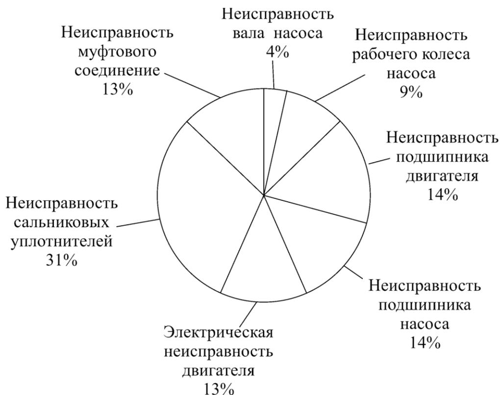
Рисунок – Диаграмма неисправностей центробежных насосных агрегатов
