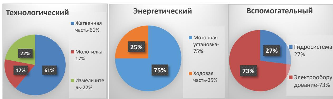
Рисунок 2 – Структура отказов элементов комбайна по модулям
