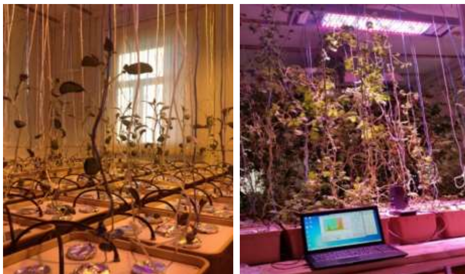
Рисунок 2 – Аэропонная экспериментальная установка с СД-облучателем
