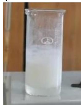
**Рисунок 2 – Определение в сметане примеси творога**
