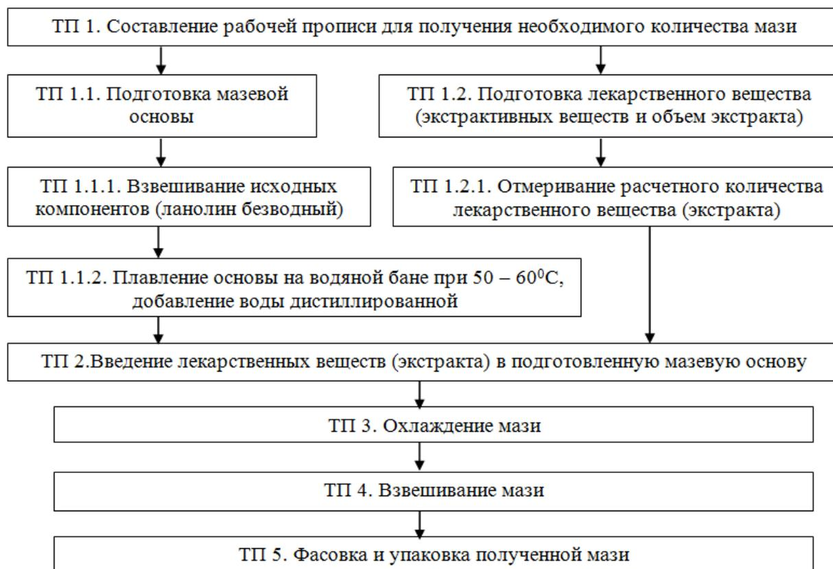
Рисунок – Технологическая схема получения мази
